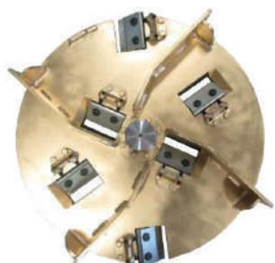
Disque breveté avec 6 couteaux sur broyeur 235
